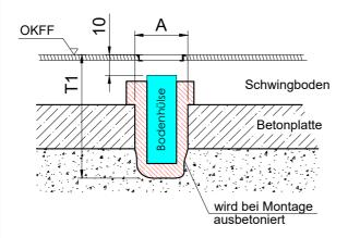
Fall 2: wasserdichte Betonplatte
